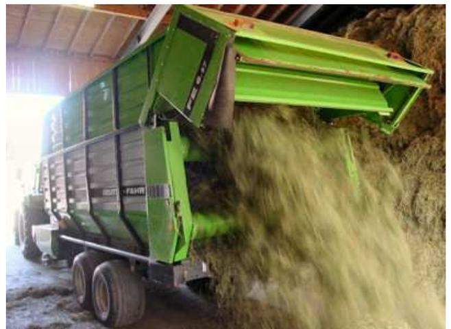
Bild 12: Abladen und Lockern mit dem Dosierladewagen
